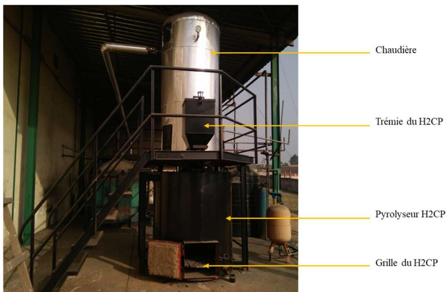
Figure 16 : Pyrolyseur H2CP couplé à une chaudière
