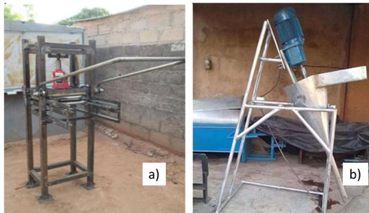
Figure 18 : a) Presse manuelle et b) Presse motorisée
