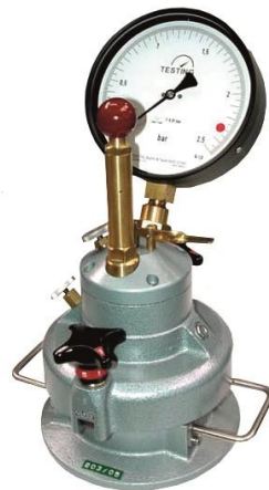
Figure II.3-5: Illustration du pycnomètre à air
