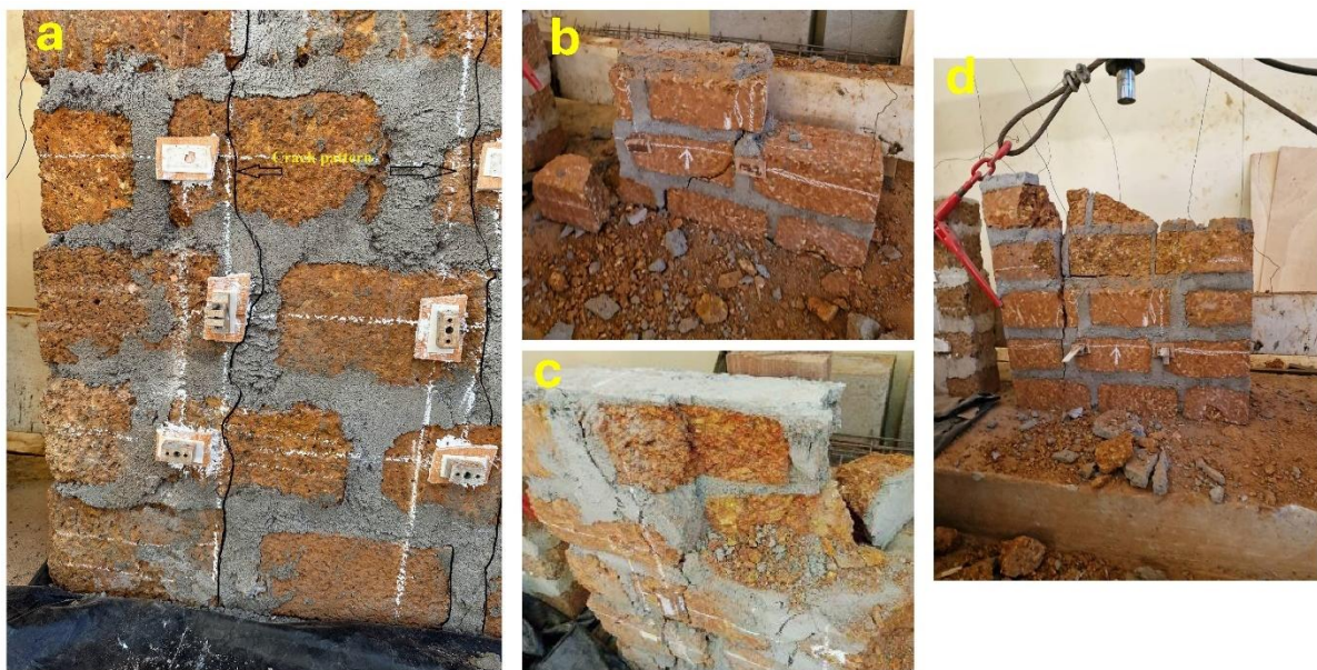
Figure II.4-13: Mode de rupture des murets en BLT avec joints de ciment a) Fissuration longitudinale du mur; b) Fissuration latérale du muret ; c) & d) Fissuration combinée longitudinale et latérale du muret
