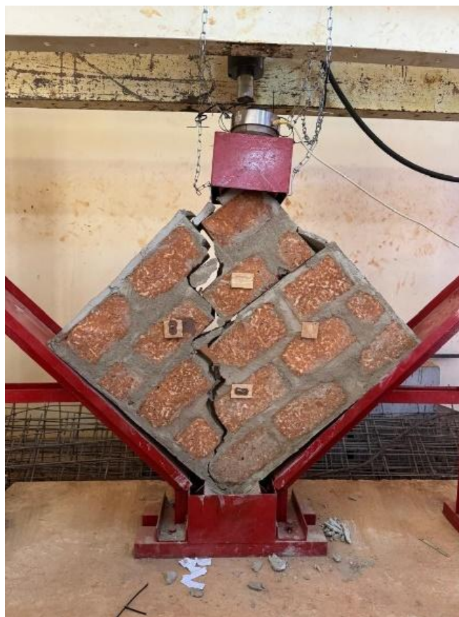
Figure II.4-15: Rupture typique et modèle de fissure après essai de cisaillement
