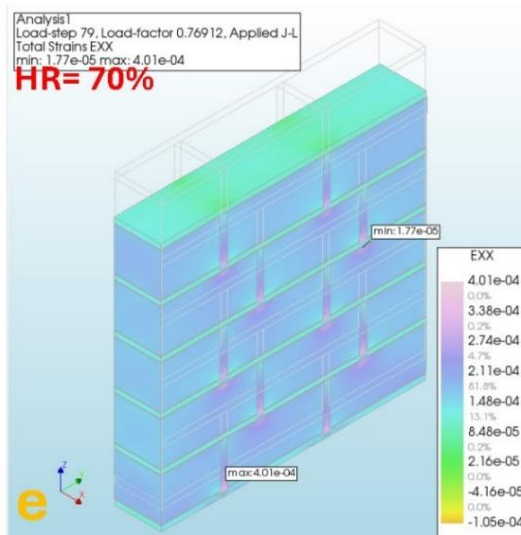
Figure IV.1-1: Évolution de la déformation normale Exx des murets de BLT en fonction des niveaux d'humidité
