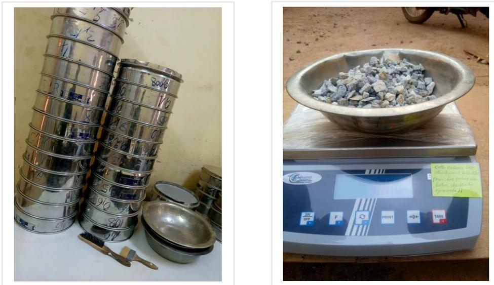
Figure 8: Balance et tamis pour l'analyse granulométrique par tamisage
