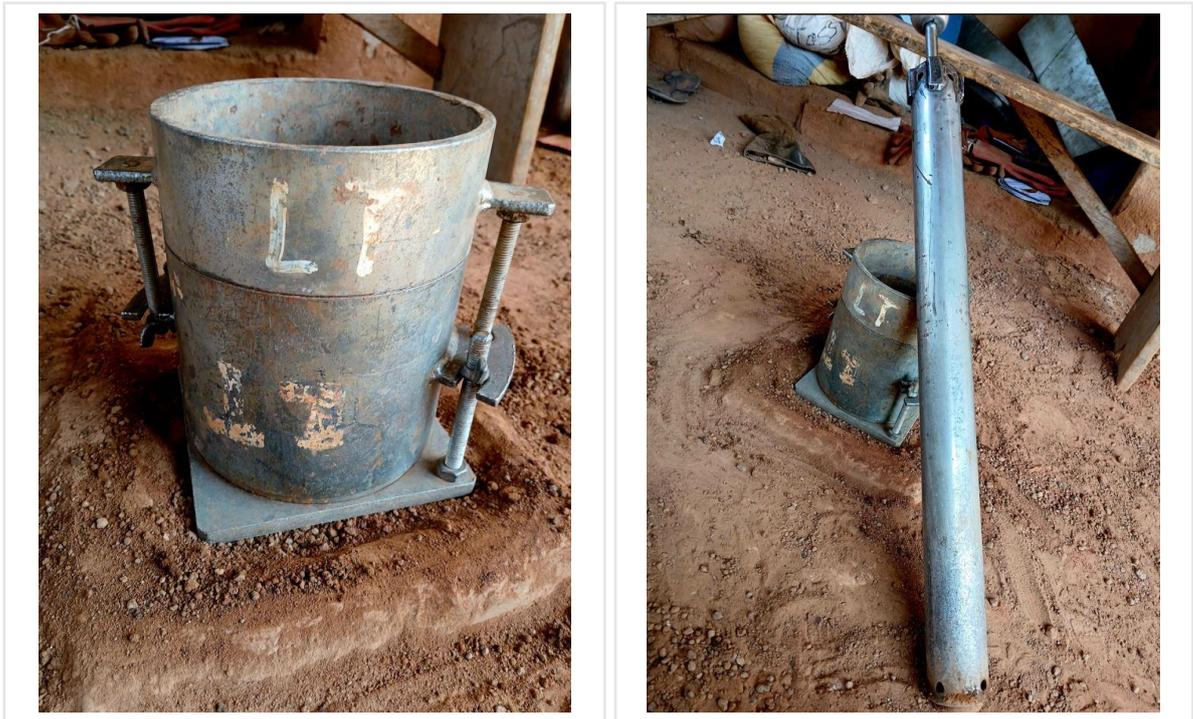
Figure 13: Moule Proctor et Dame Proctor
