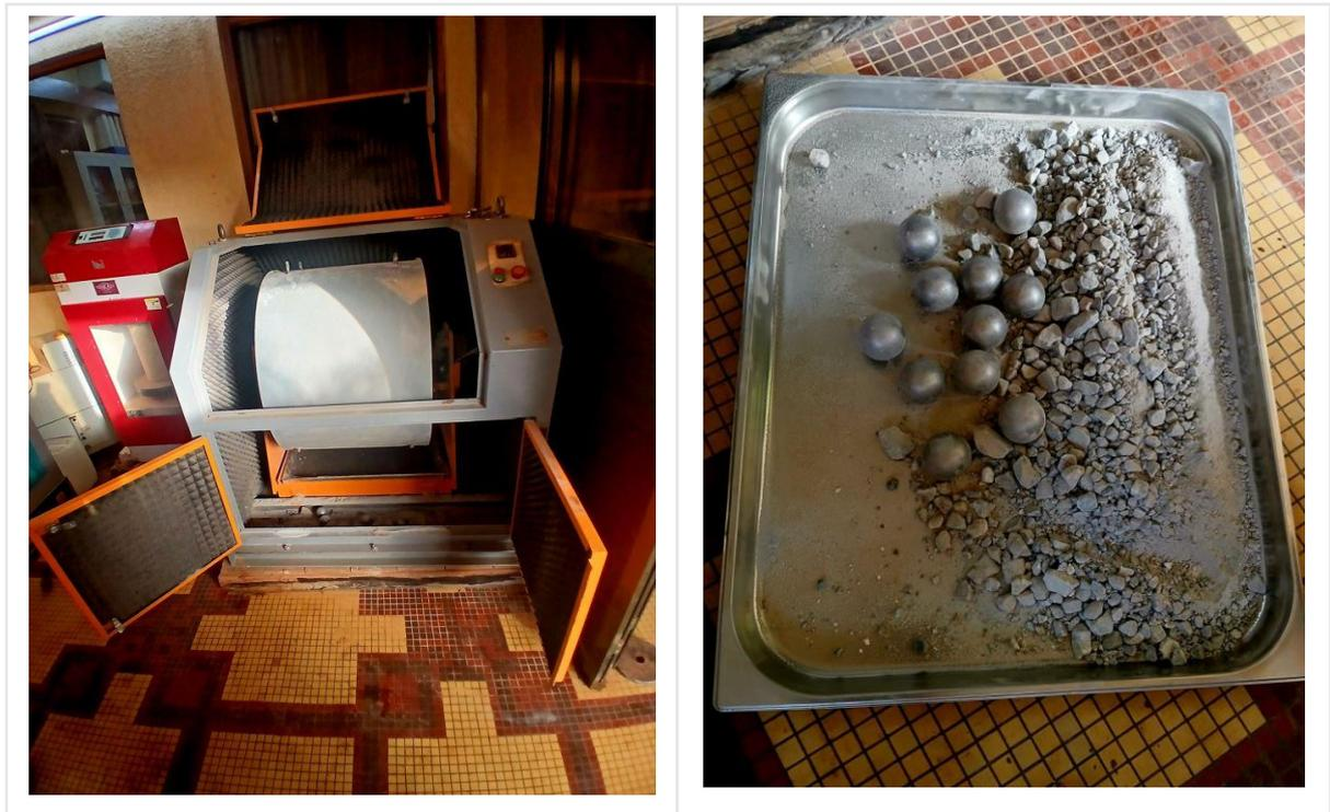
Figure 15: Boulets et appareil pour l'essai Los Angeles
