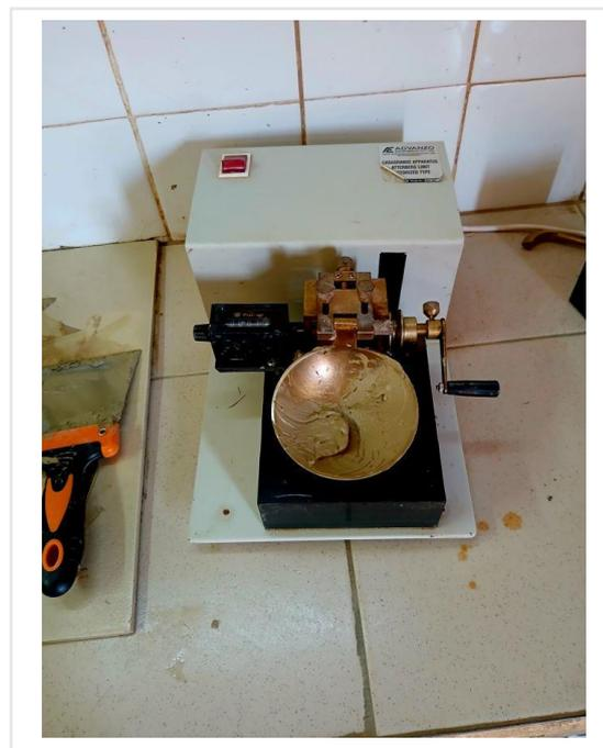
Figure 11: Appareil de casagrande pour la limite de liquidité
