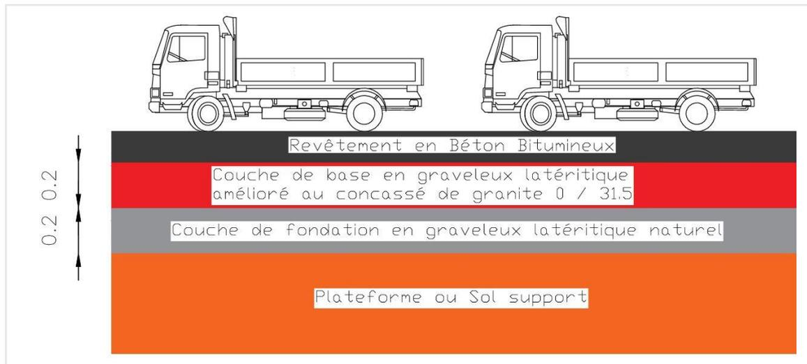
Figure 4: Structure de la chaussée sur l'avenue Mogho
