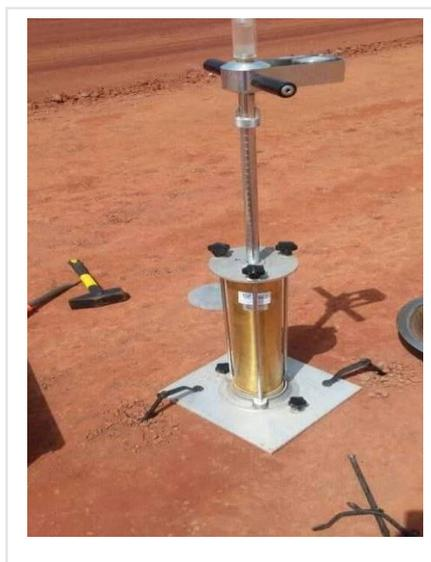
Figure 32:l'essai au densitomètre à membrane
