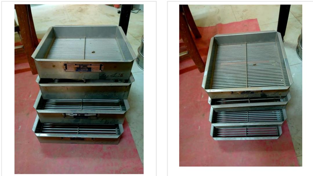
Figure 12: Grille pour l'essai d'aplatissement
