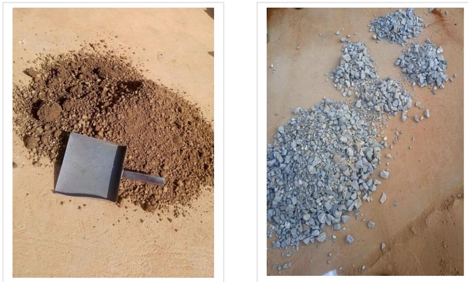
Figure 7: Echantillonnage par quartage des matériaux
