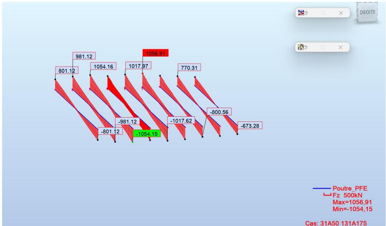
Figure 11: Diagramme des efforts tranchants à l'ELU des poutres
