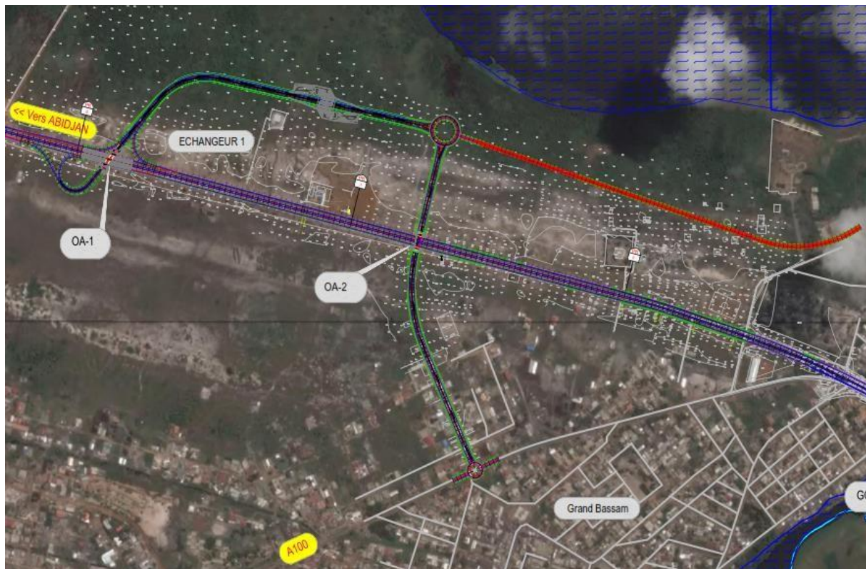
Figure 4: Schéma de l'échangeur n°1 de Grand Bassam.
