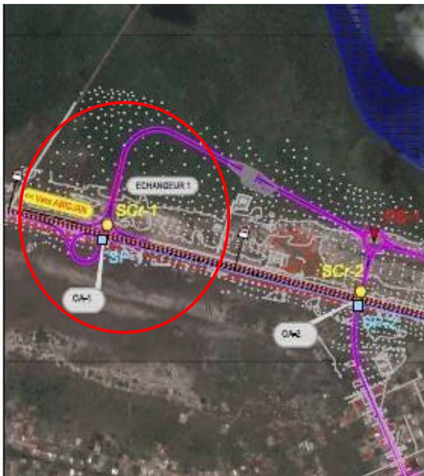
Figure 6: Implantation des sondages géotechnique
