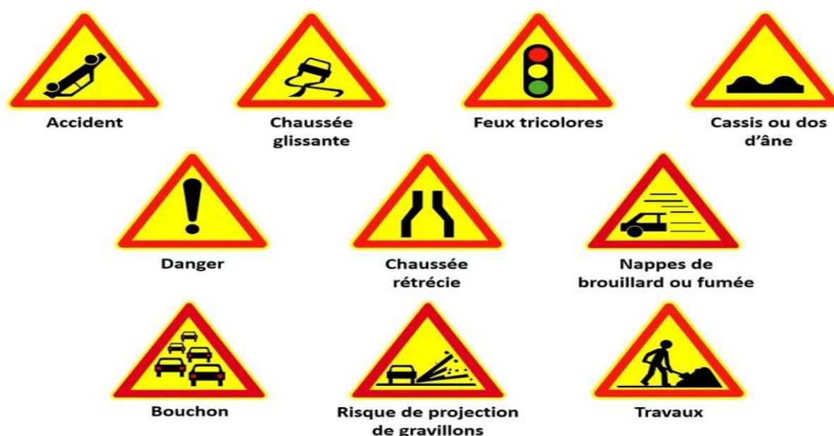
Figure 9 : Panneaux de signalisation temporaire
