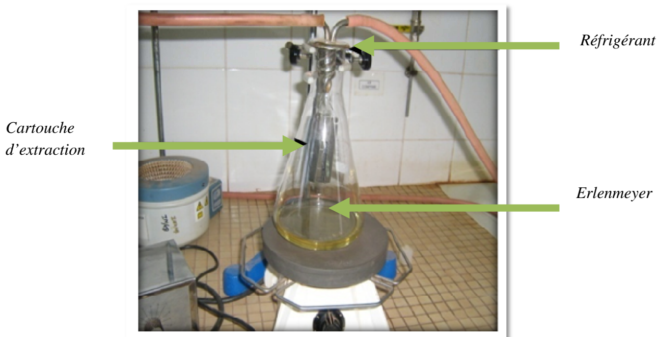
Figure 6 : Appareil d'extraction pour la détermination de la teneur en sédiment
