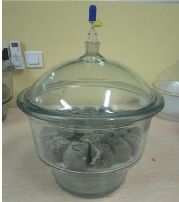
Figure 12 : échantillon dans le dessiccateur pour essai de sorption
