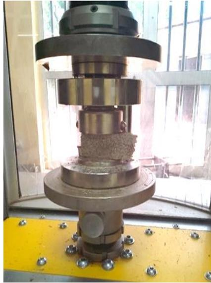
Figure 10 : Essais de compression sur un échantillon avec la 3R
