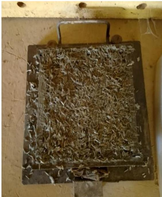
**Figure 5 : Moule + béton de balle de riz**
