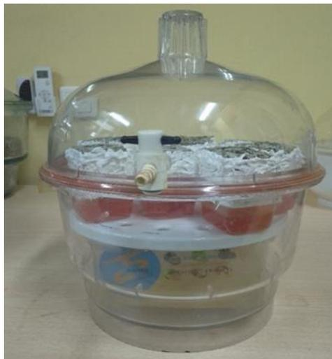
Figure 13 : Essai de perméabilité à la vapeur
