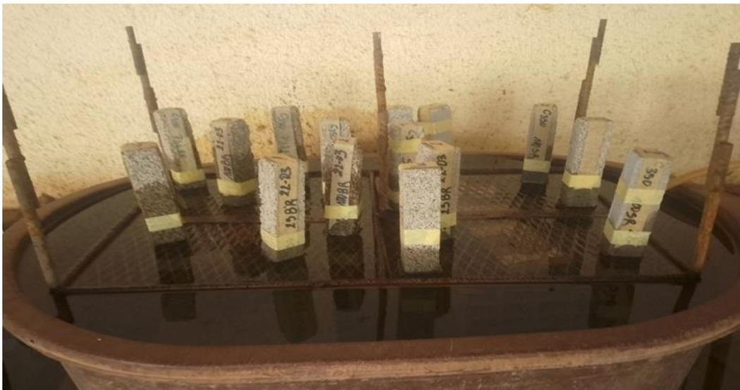
**Figure 8 : Dispositif d'absorption capillaire**
