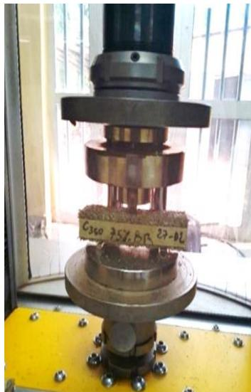
Figure 9 : Essais de flexion sur un échantillon avec la 3R
