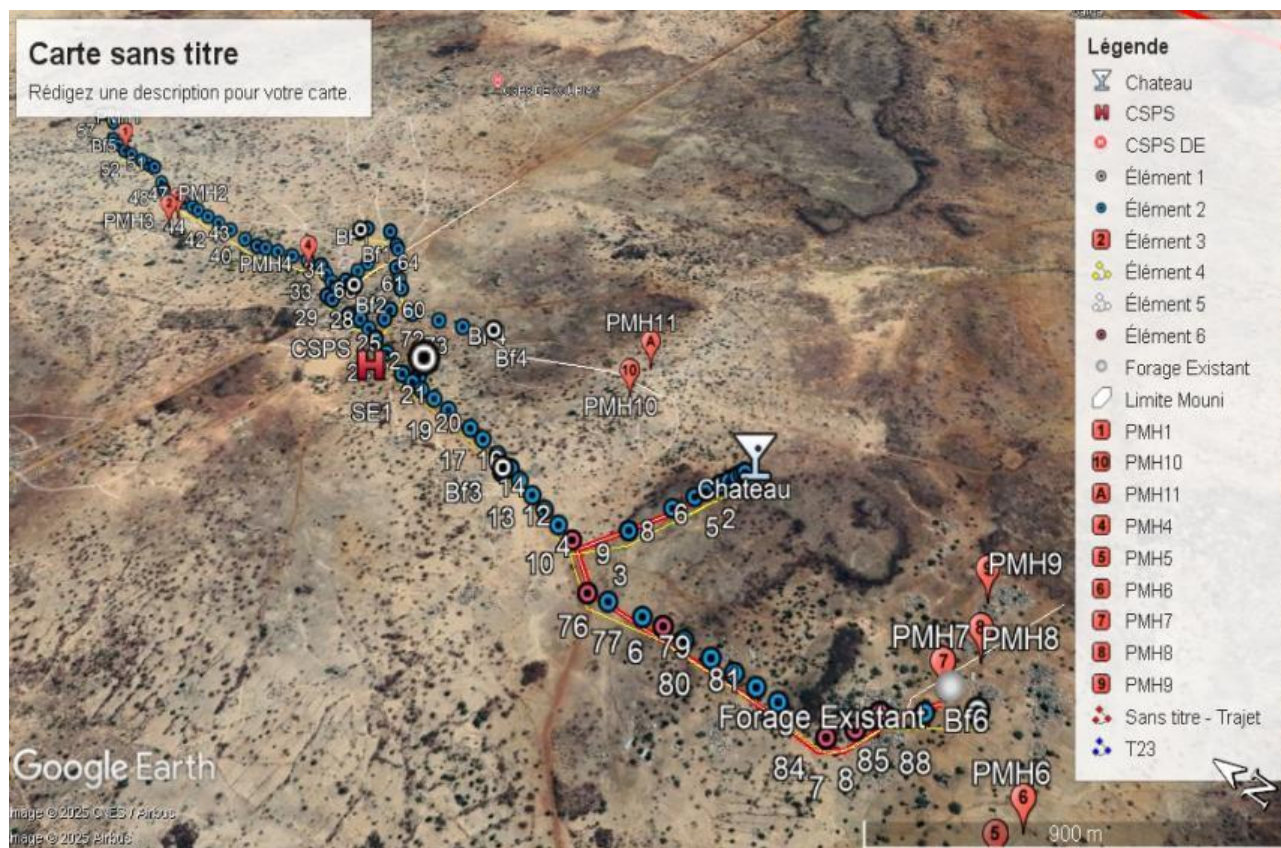
Figure 7: Réseau de distribution du village de MOUNI
