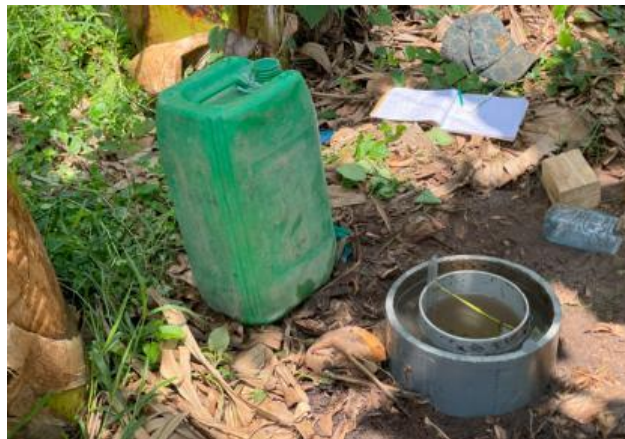
Figure 5: Essai d'infiltration au double anneau
