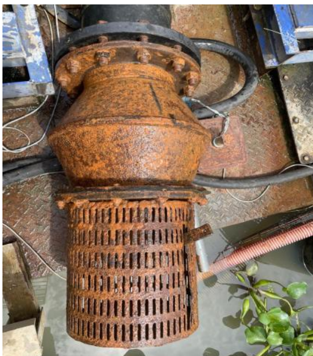
Une crépine à clapet anti-retour
