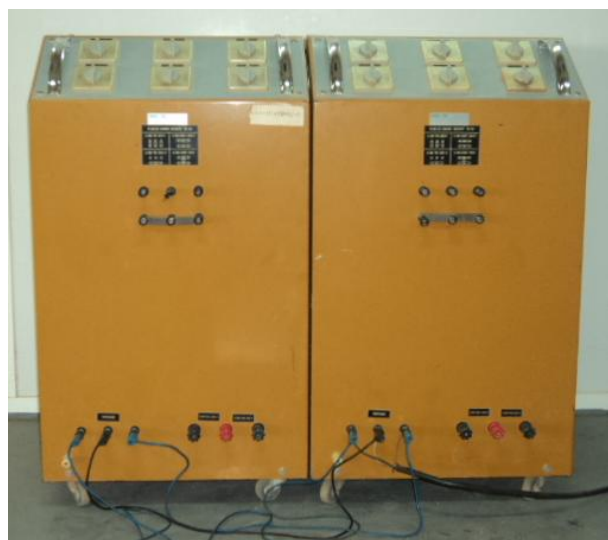
Photo 2 : bancs de charge
