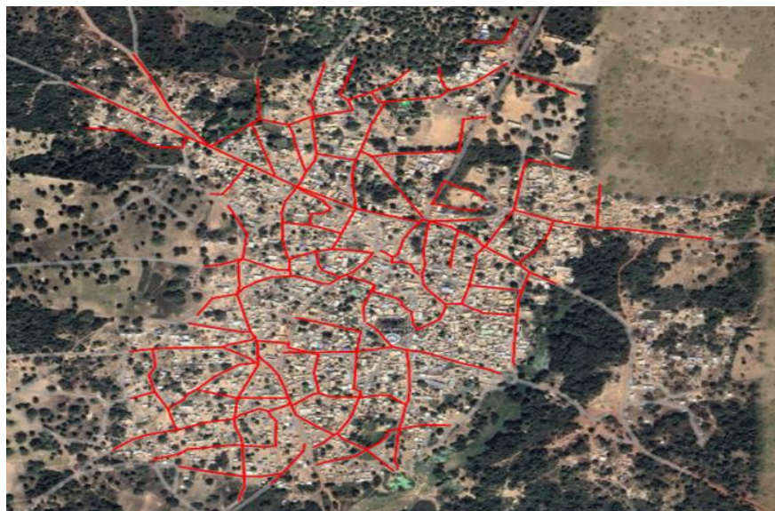
Figure 11. Tracé du réseau de distribution BT de Fourkoura
