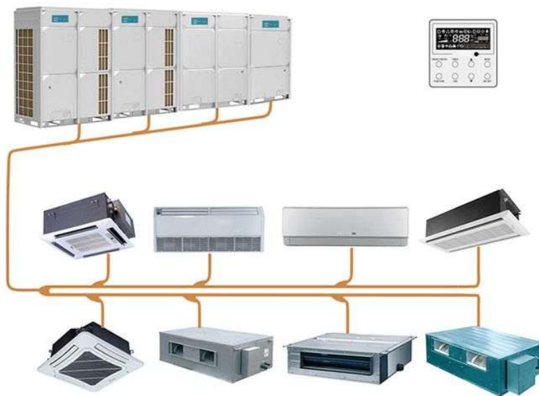
Figure 1 : Schéma de principe d'un système VRV [2]
