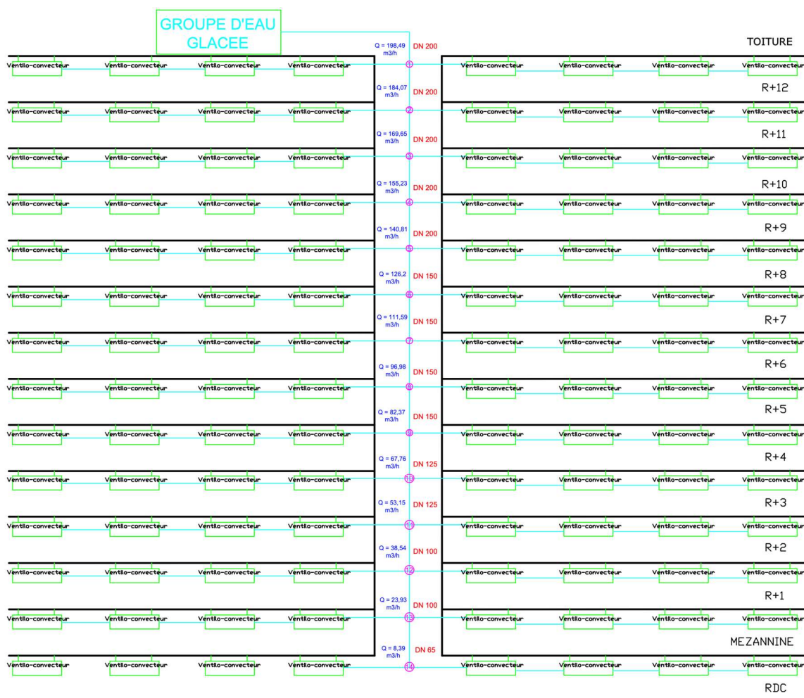
Figure 10 : Distribution de l'eau glacée dans le bâtiment
