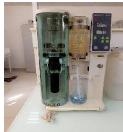
Distillateur NTK (BÜCHI Unit K-355)
