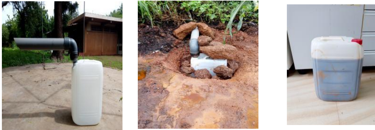
Figure 7: Dispositif de collecte des lixiviats pluviaux (installation et collecte). Cliché Pascal, septembre 2022.
