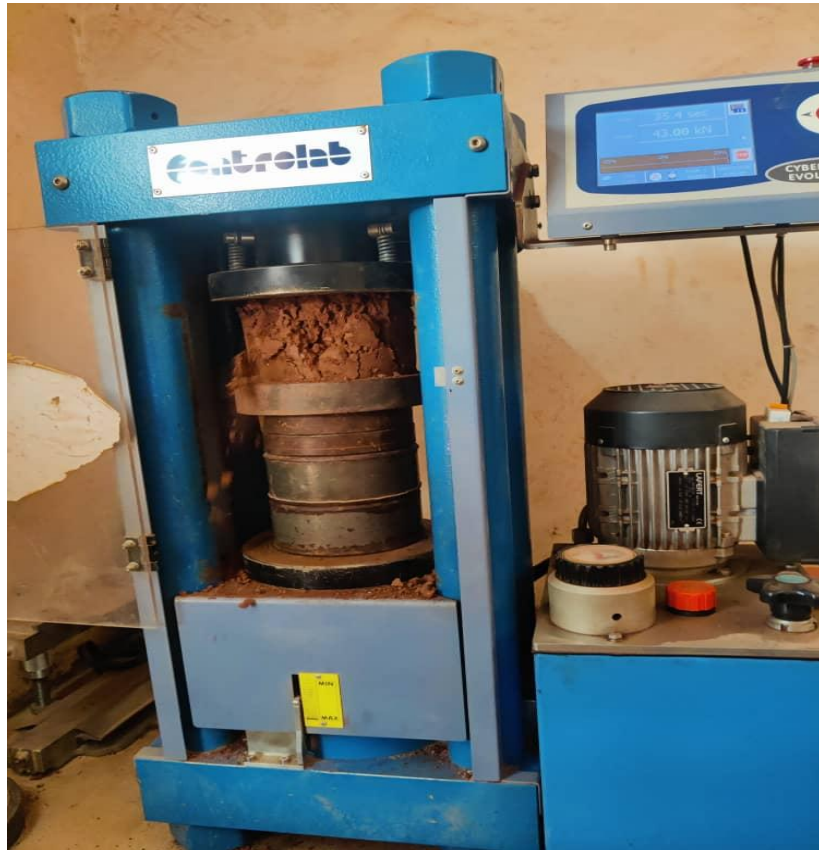
Figure 10 : Illustration de l'essai de compression simple avec la presse hydraulique
