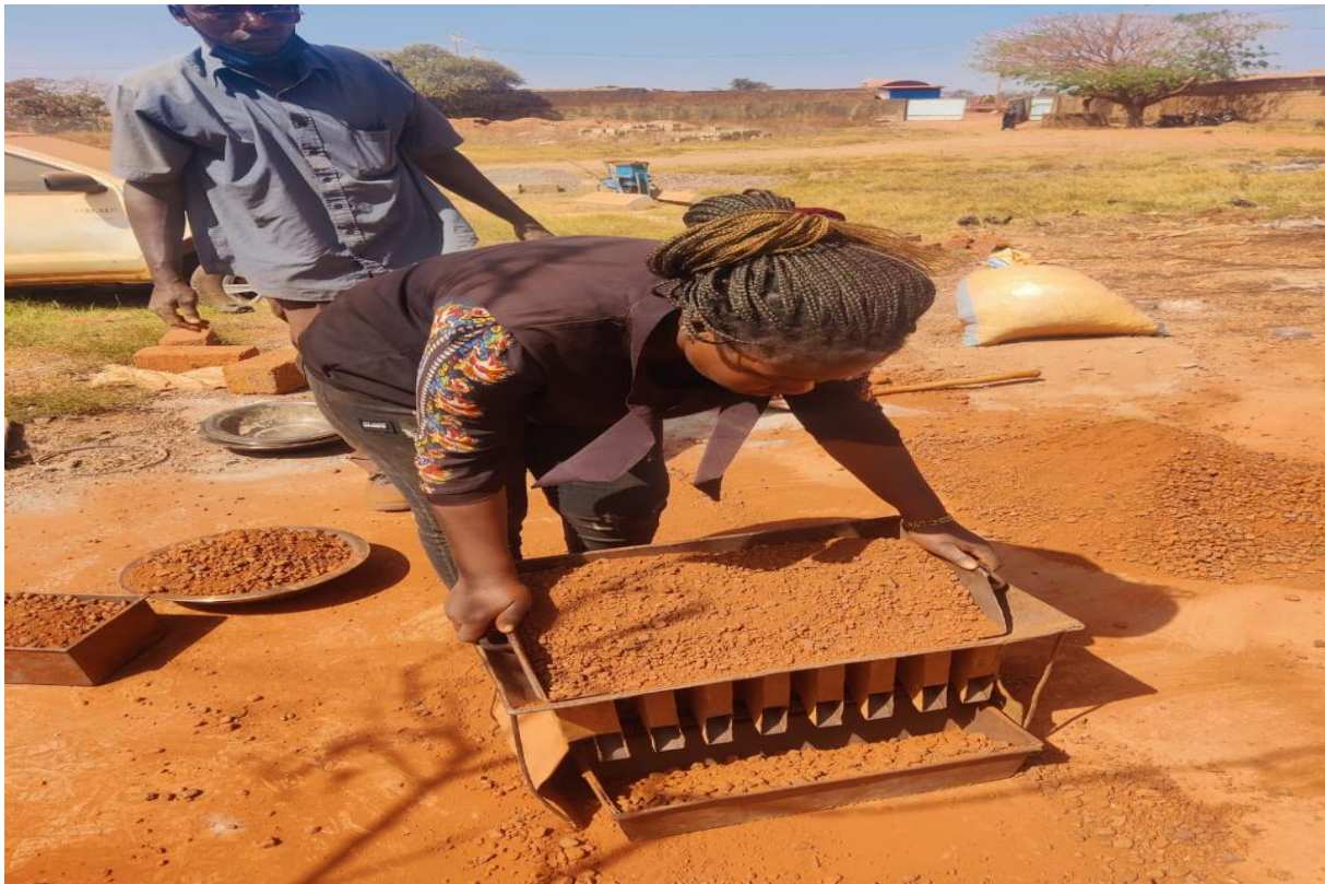
Figure 6 : Echantillonnage du matériau par la méthode de l'échantillonneur
