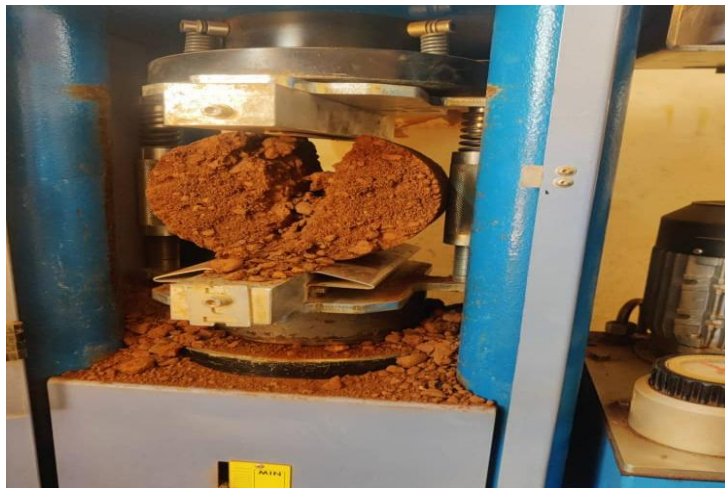
Figure 9 : Mise en œuvre de l'essai de traction par fendage avec la presse hydraulique
