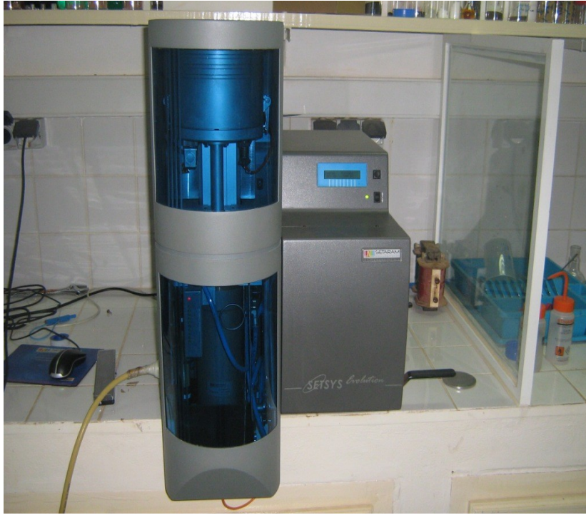
Figure 6: Analyseur thermogravimétrique (SETSYS SETARAM)
