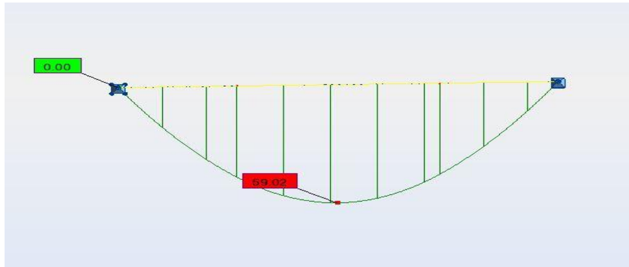
Figure 8 : Diagramme des moments de l'escalier à l'ELU
