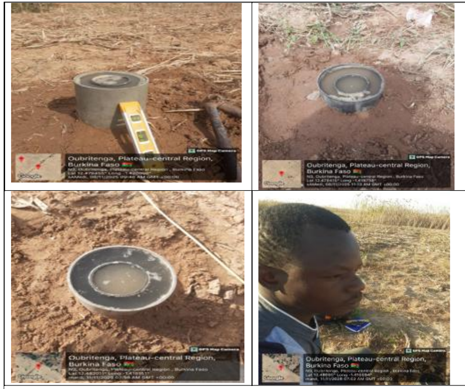
Figure 25 : Dispositif de mesures de l'infiltration
