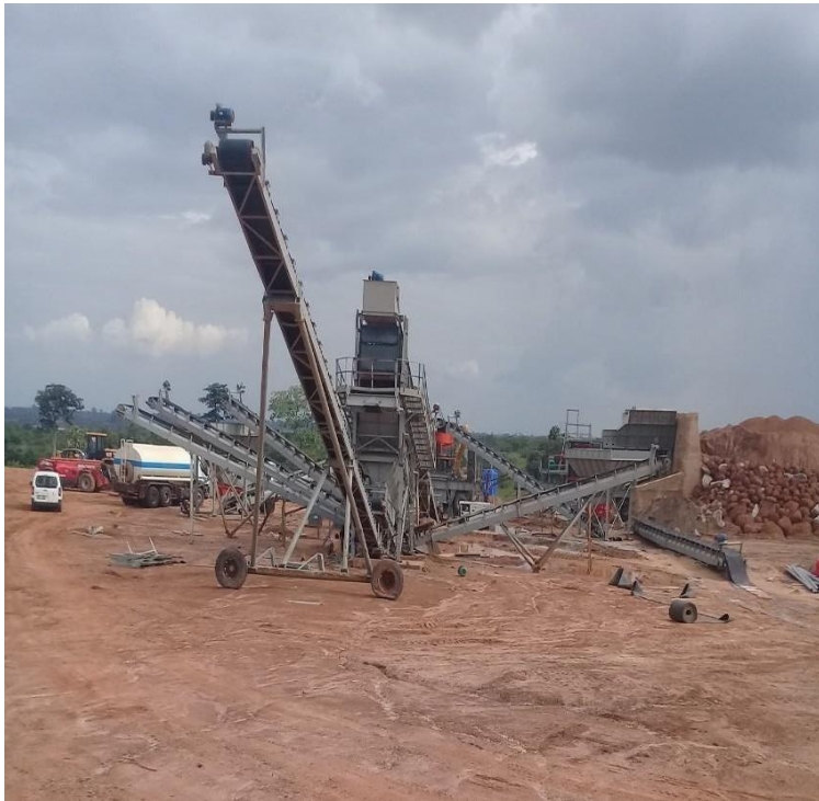
Photos 1 et 2 : Installation de la centrale de concassage de Tiébissou
