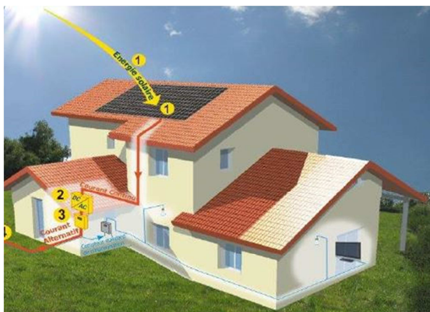
Figure VII : Principe de fonctionnement des kits solaires Premium
