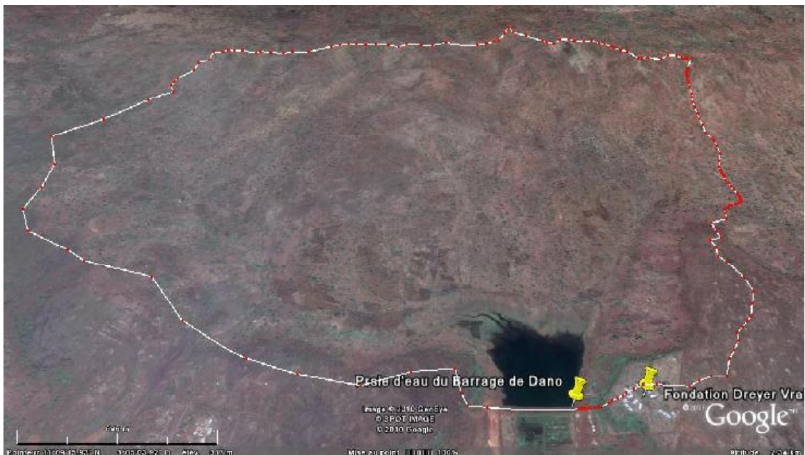
Figure 3: Délimitation du bassin versant du barrage de Moutori réalisée sous Google Earth
