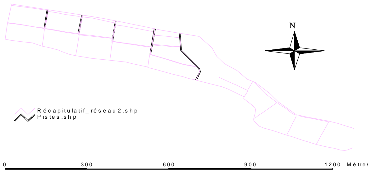
Figure 8: Réseau des pistes du périmètre de Moutori réalisé sous Arcview
