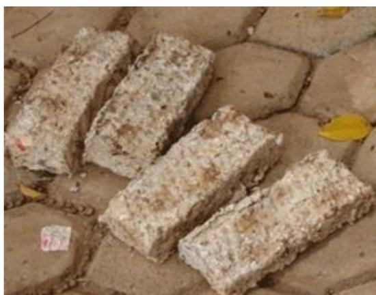
*Photo 8 : Briquettes de chauffe fabriquées à base de déchets papier et carton*
