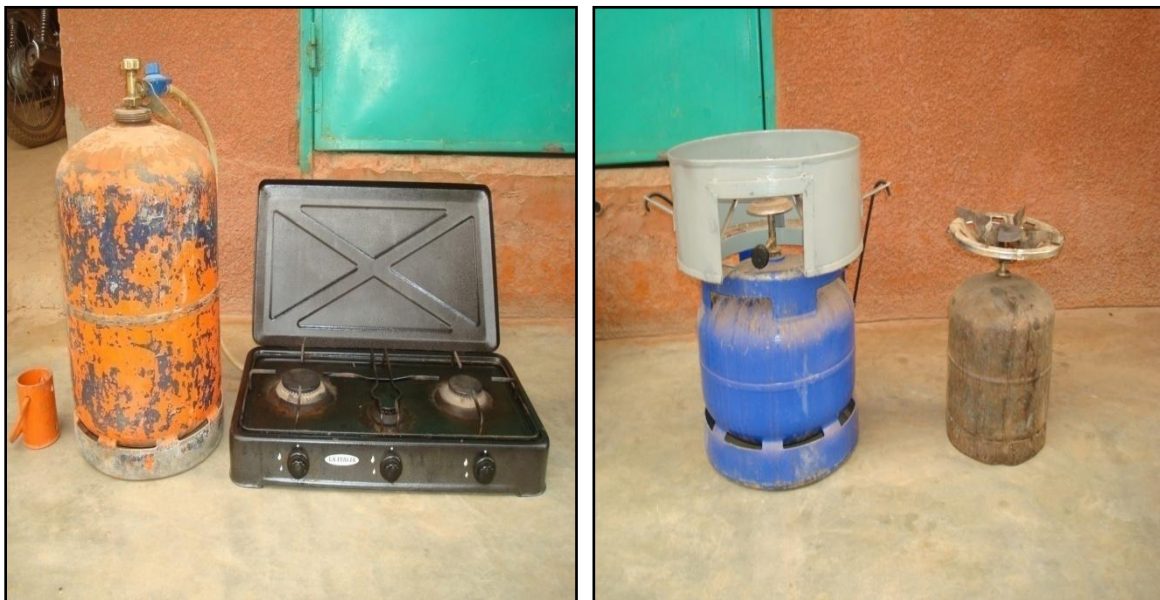
Photo4: Type d'appareillage d'une bouteille de gaz de 12,5kg, 6kg et de 2.75 kg
