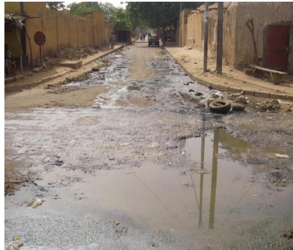
**Figure 24:** Ecoulement des eaux usées sur la rue pavé
