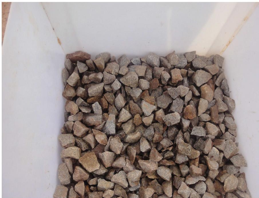
**Figure 13 : Gravier de granulométrie comprise entre 15 et 30mm**
