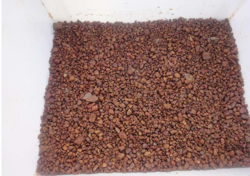
**Figure 14: Galet de granulométrie comprise entre 7 et 15mm**
