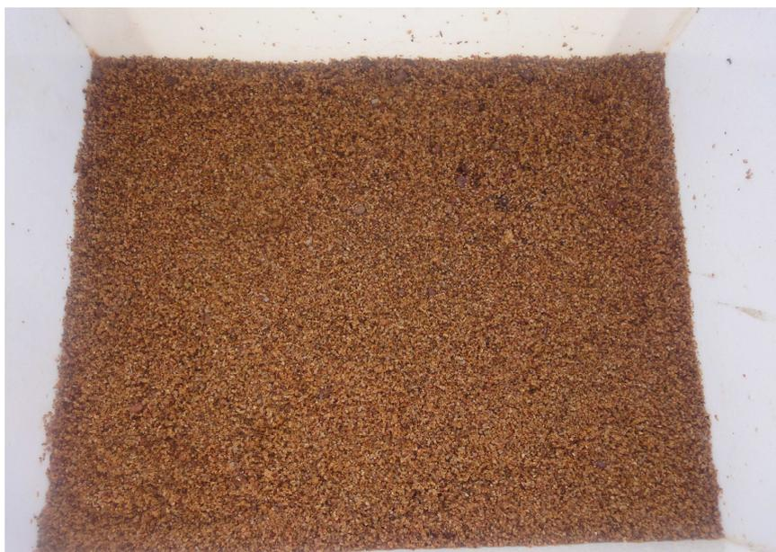
**Figure 15: Sable de granulométrie comprise entre 7 et 15mm**
