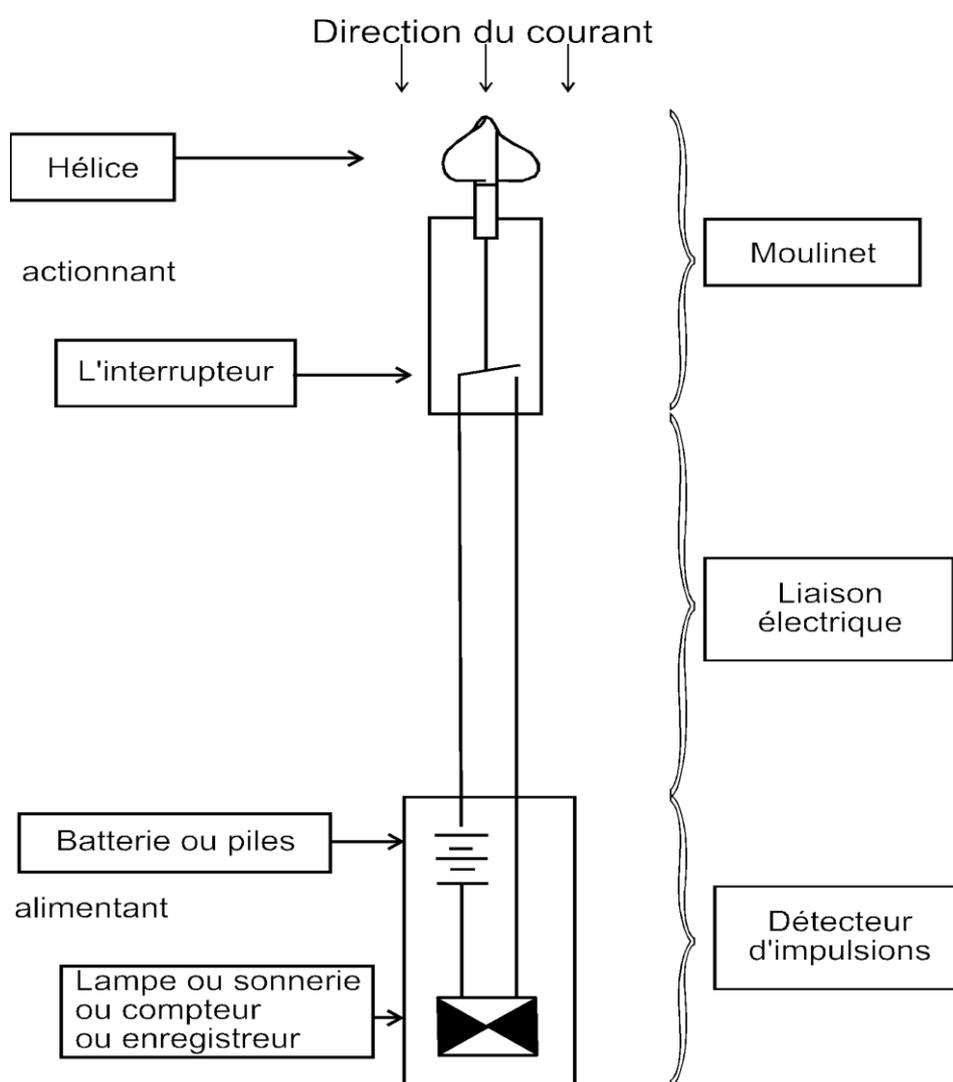
Figure 2 : Schéma de fonctionnement d'un moulinet à axe horizontal (tiré de G. JACCON).
