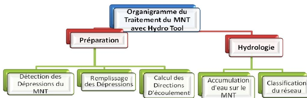
**Figure 8 : Préparation à l'extraction du réseau hydrographique.**
