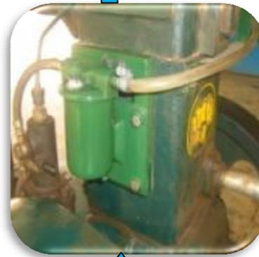
*Fixer le support au monter par des vis de 15*
