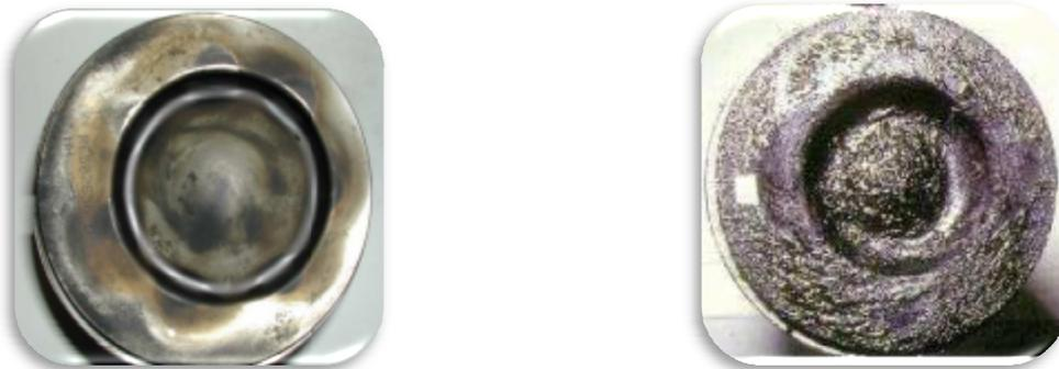
Figure 3 : Encrassement du piston, Photo CIRAD [10]
