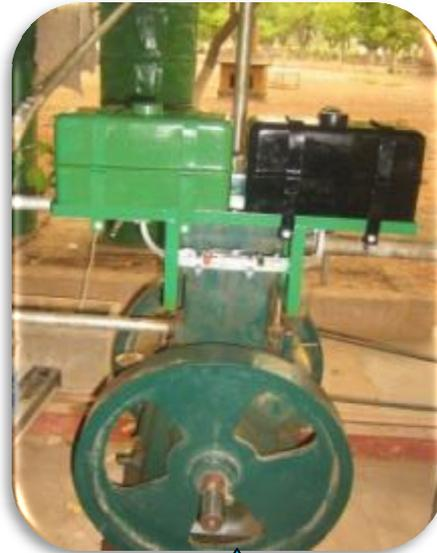
*Démonter le réservoir d'origine*
