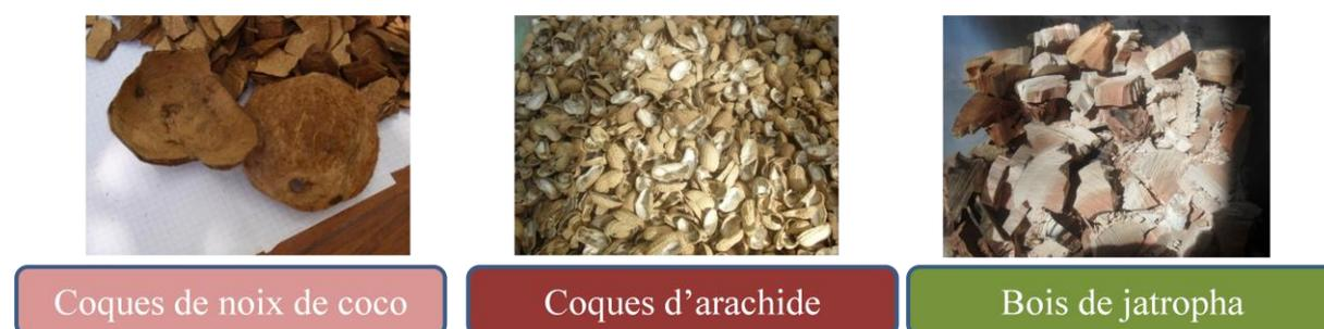
Figure 3: Biomasses utilisées pour la fabrication de nos charbons
