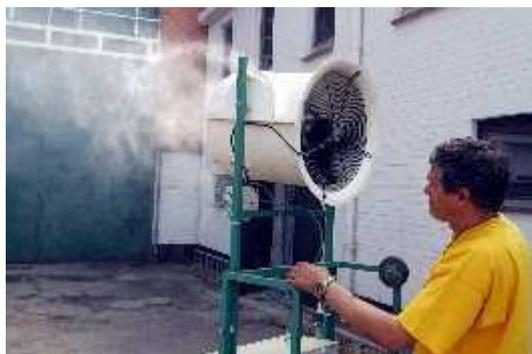
*Figure 1: Humidificateur centrifuge*
