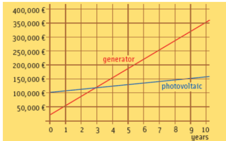
Figure 7: comparaison des coûts initiaux et d'exploitation entre PV et groupe diesel, cas d'une station de télécommunication de puissance 10 kW [2]
