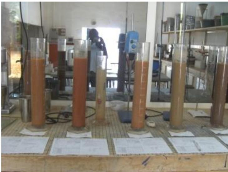
**Photo 8 : Décantation des échantillons de sol dans des éprouvettes graduées**
