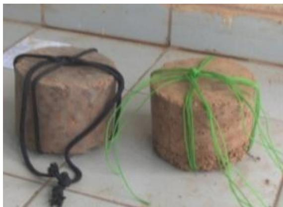
**Latérite stabilisée- Latérite crue avant immersion**
