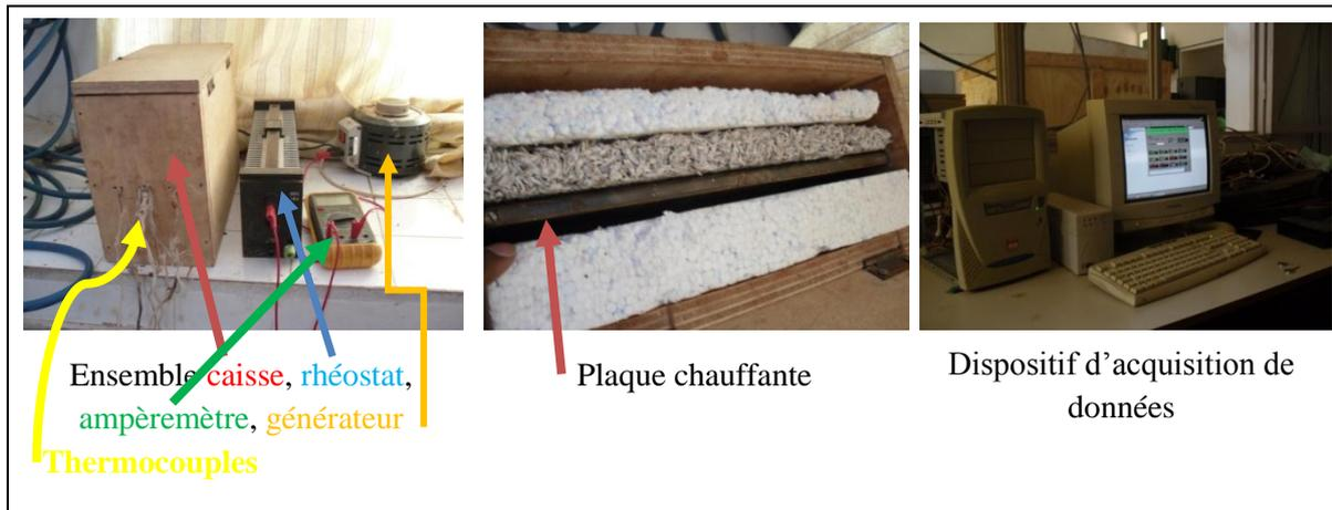
**Photo III 4: dispositif expérimental du plan chauffant**
