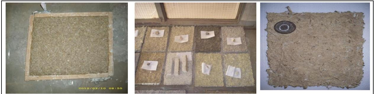
**Photo III 3: séchage des panneaux**
