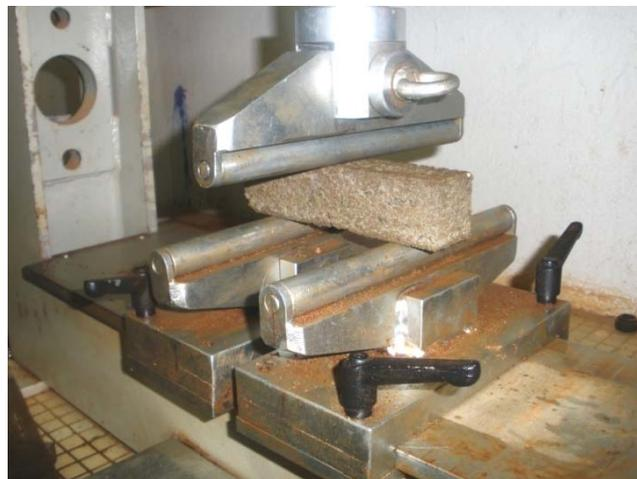
*Photo n°3 : Dispositif d'essai de la résistance à la traction par flexion*
