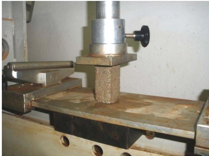
*Photo n°4 : Dispositif d'essai de la résistance à la compression*
