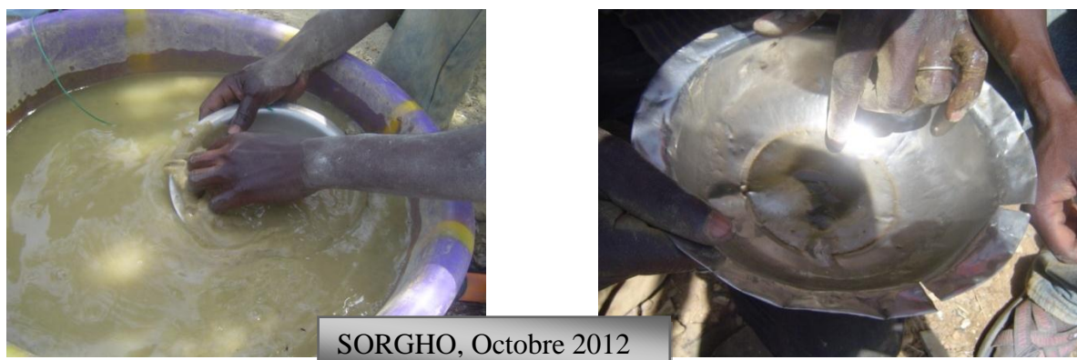
Figure 3: Vannage et test du minerai
