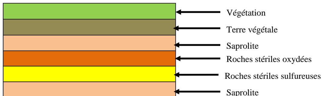
Figure 3 : Disposition alternée des différentes couches de stériles
