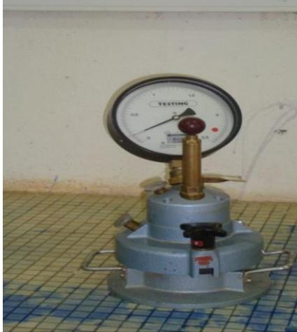
**Photographie x :** Le pycnomètre à air.
