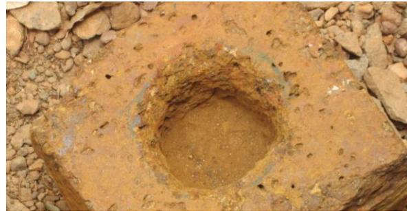
Un bloc de latérite taillée de dimension 15×15×15 cm dont on a creusé un trou de 7 cm de diamètre et de 8 cm de profondeur.
