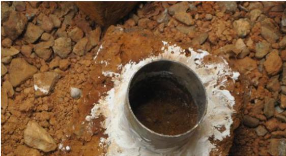
Un bloc de latérite taillée de dimension 15×15×15 cm sur lequel a été collé un tuyau pvc de 8 cm de diamètre.
