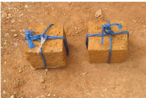
Les blocs de latérite avant immersion dans l'eau
