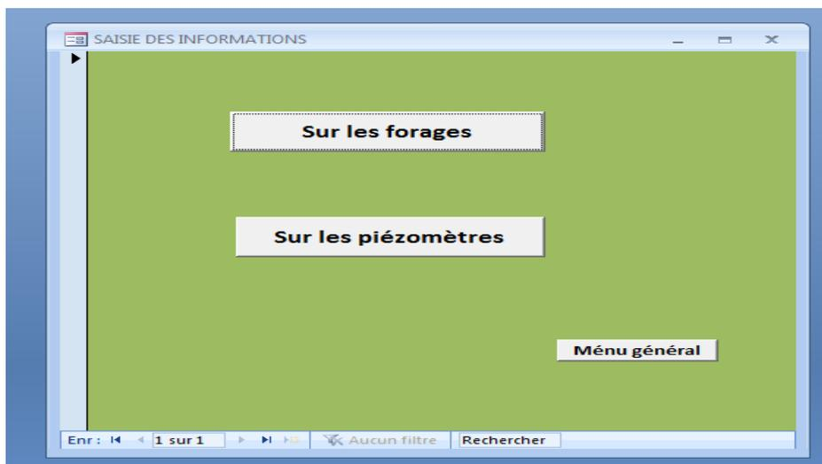
Où on peut choisir de saisir soit les données sur les forages ou sur les piézomètres. En cliquant sur les forages on ouvre la boîte de dialogue suivante :
