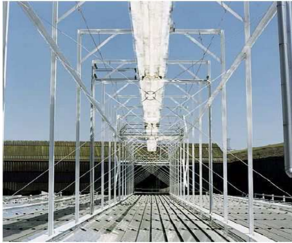
Annexe 1.4 : prototype de capteur CLFR à liège ( source : [3])
