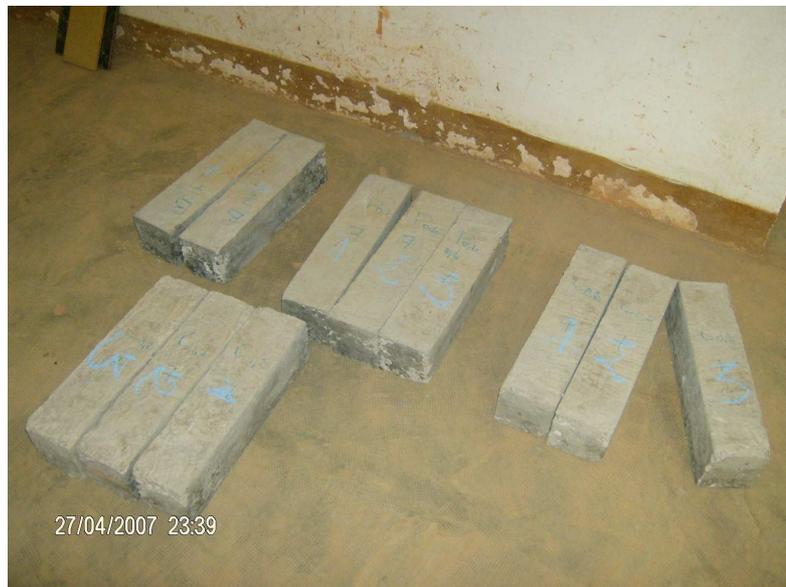
Photo 9: Aspect des éprouvettes après décoffrage.
