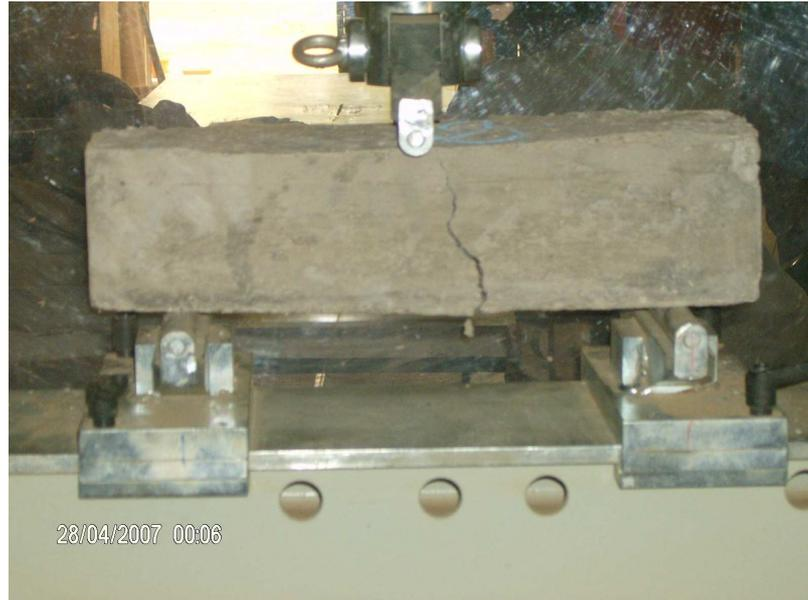
Photo 13: Mode de rupture des éprouvettes béton dosée aux fibres de coton (1,2 Kg/m<sup>3</sup>)
