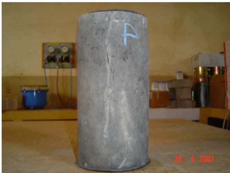
Photo 6: Epreuves en béton dosé aux fibres de polypropylène (0,6 Kg/m<sup>3</sup>)
