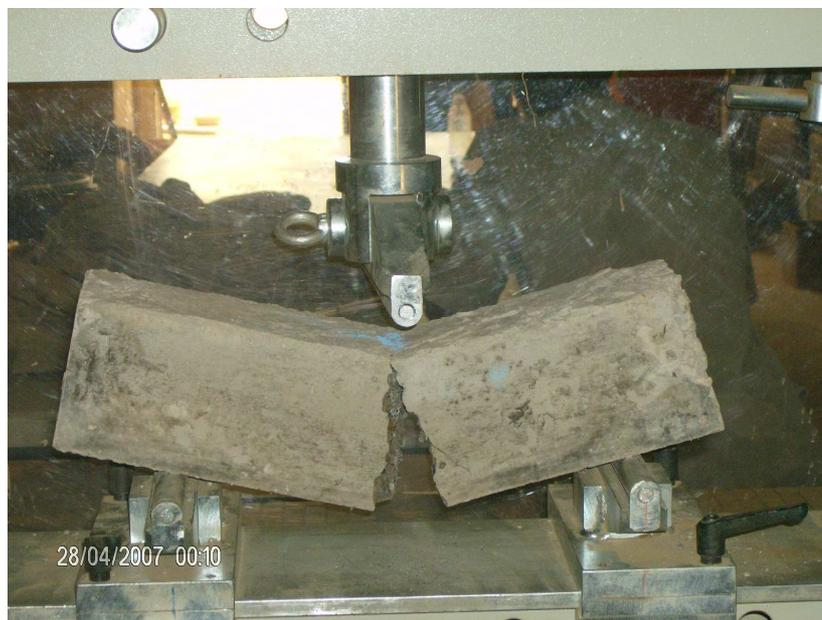
Photo 12: Mode de rupture des éprouvettes béton dosée aux fibres de coton (0,6 Kg/m<sup>3</sup>)
