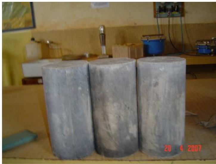
Photo 2: Eprouvettes béton témoin
