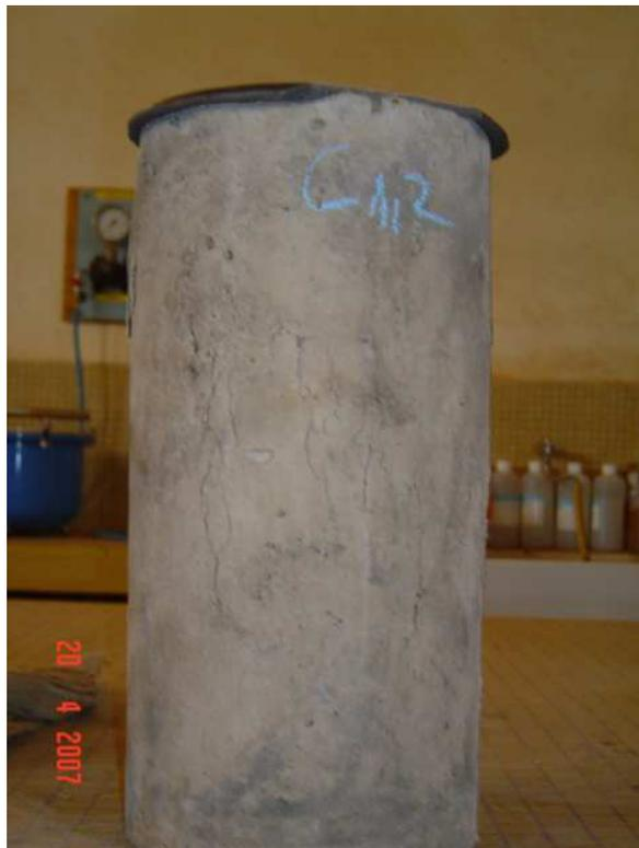
Photo 8: Epreuves en béton dosé aux fibres de coton (1,2 Kg/m<sup>3</sup>)
