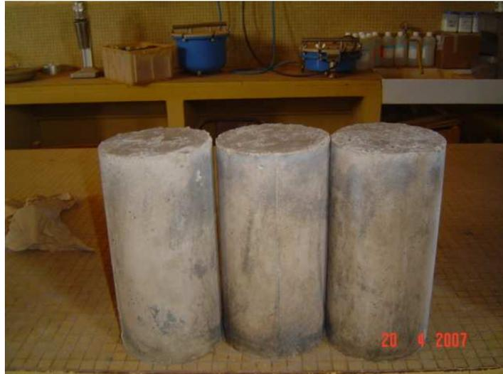
Photo 3: Epreuves en béton dosé aux fibres de coton (1,2 Kg/m<sup>3</sup>)
