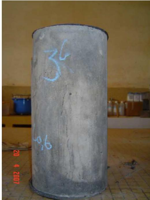
Photo 7: Epreuves en béton dosé aux fibres de coton (0,6 Kg/m<sup>3</sup>)
