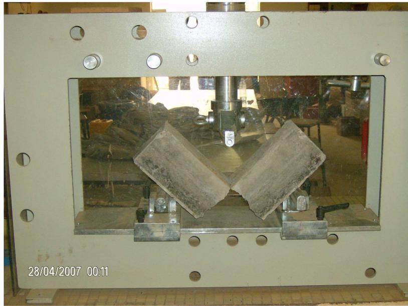
Photo 11: Mode de rupture des éprouvettes béton témoin.
