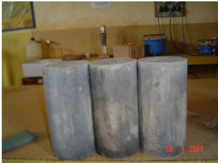
Photo 4: Epreuves en béton dosé aux fibres de polypropylène (0,6 Kg/m<sup>3</sup>)
