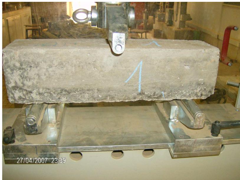
Photo 10: Photo de l'éprouvette sur le portique d'essai universel
