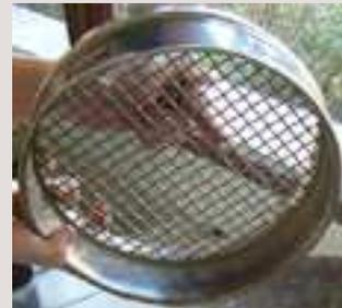
Les tamis sont également repérés par un numéro d'ordre appelé **module**. Le premier tamis, 0,08 a comme module le numéro 20, le suivant le module 21 et ainsi de suite selon une progression arithmétique de raison 1.
