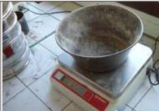
Un récipient pour recueillir les granulats, est posé sur la balance. La balance est tarée.
