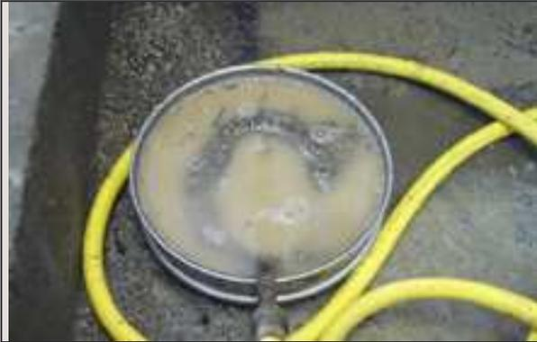
Tamisage des fines par lavage en utilisant le plus petit tamis de l'analyse.
