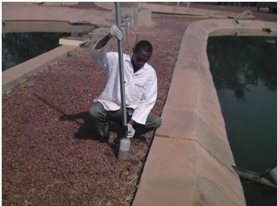
**Figure 9** : Séance de prélèvement d'échantillons au « water column sampler » (2iE, mai 2007).
