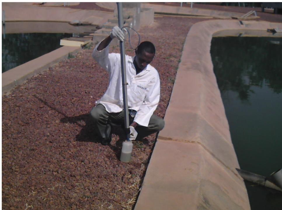
**Annexe 15** : Séance de prélèvement d'échantillons au « water column sampler ».
