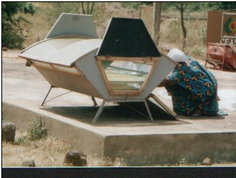
Photo 1-1 : Séchoir solaire tunnel
