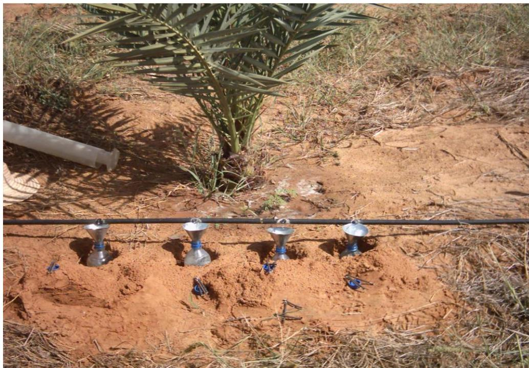
Photo 3 : Dispositif de mesure du volume d'eau au niveau de la parcelle de dattier
