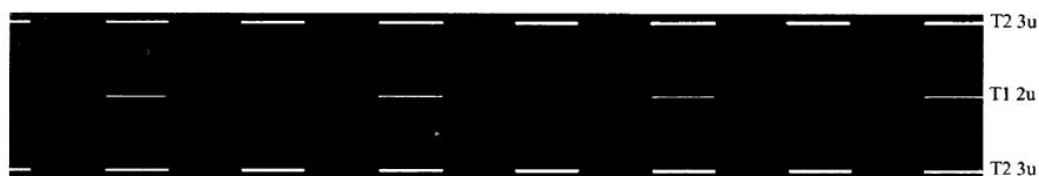
Figure 10 : Route à 2 voies en rase campagne
