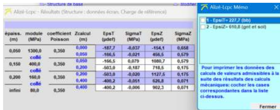
Figure 2-1 : Première vérification de la structure
