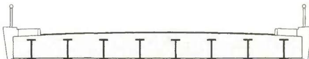
Figure.13 : Coupe transversale pont à poutrelle enrobée [4]
