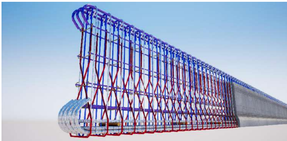
Figure III-13 : modèle BIM Reinforcement de la poutre
