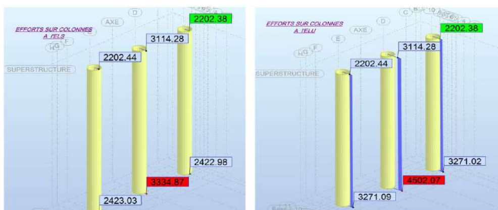
Figure : Diagramme des efforts sur colonnes à ELS et ELU
