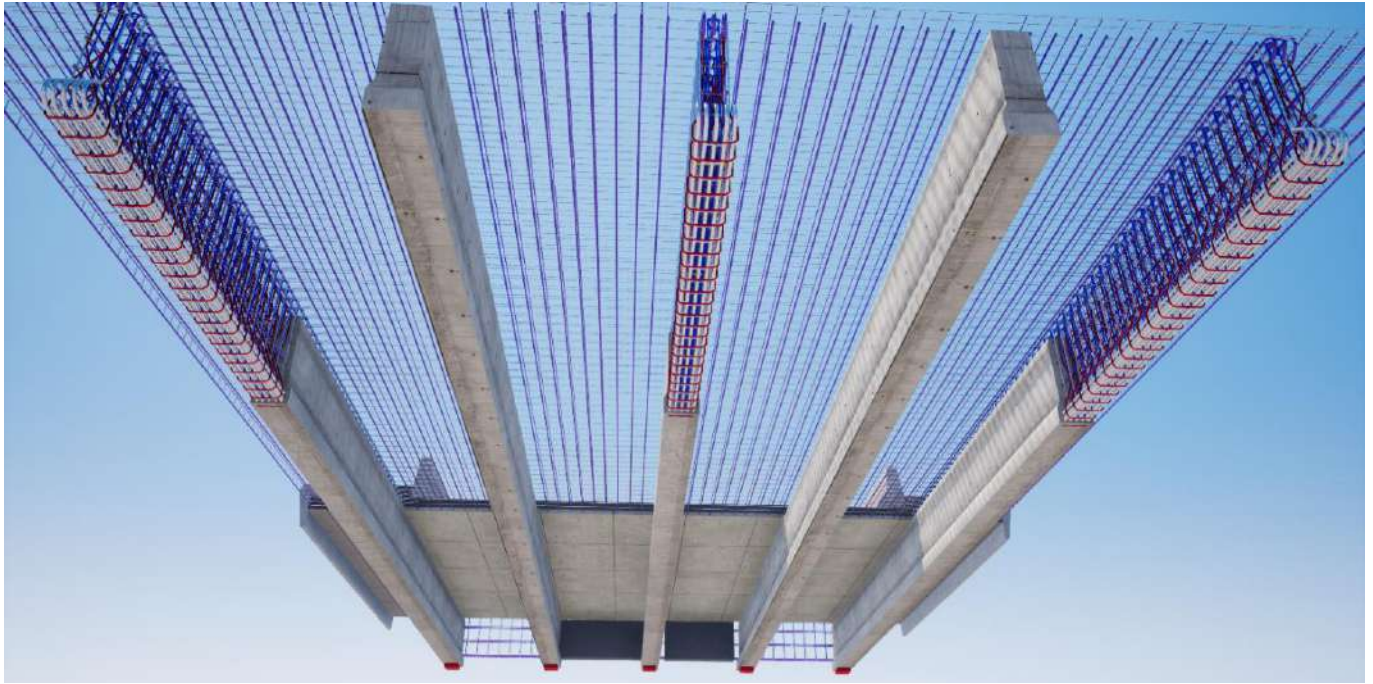
Figure III-16 : modèle BIM Reinforcement du tablier
