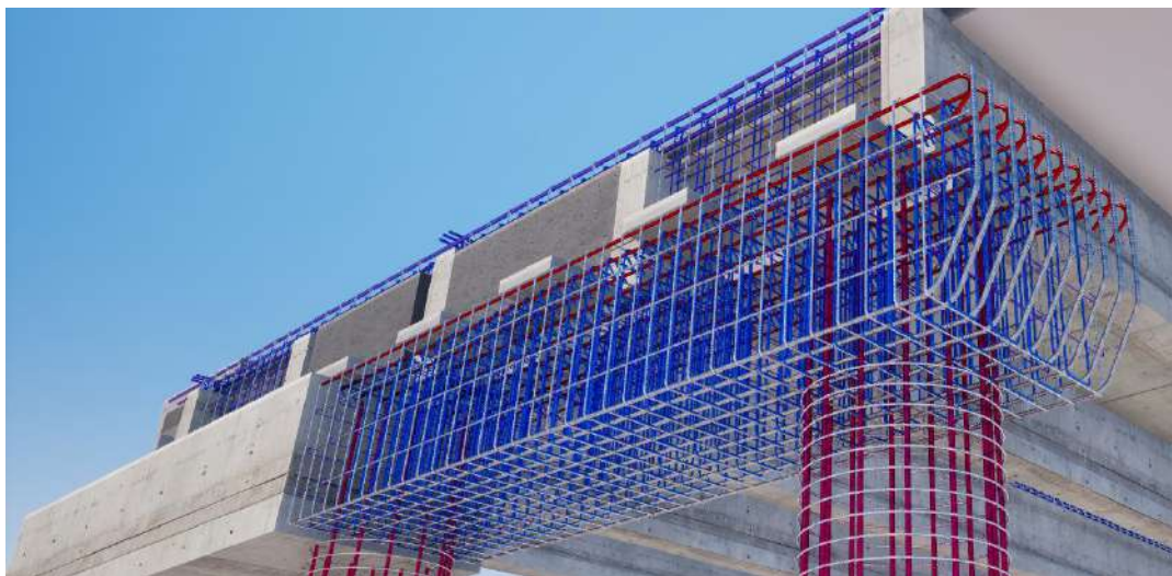
Figure III-27 : modèle BIM Reinforcement du chevêtre
