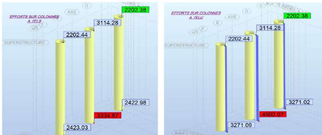
Figure III-28 : Diagramme des efforts sur colonnes à l'ELS et à l'ELU
